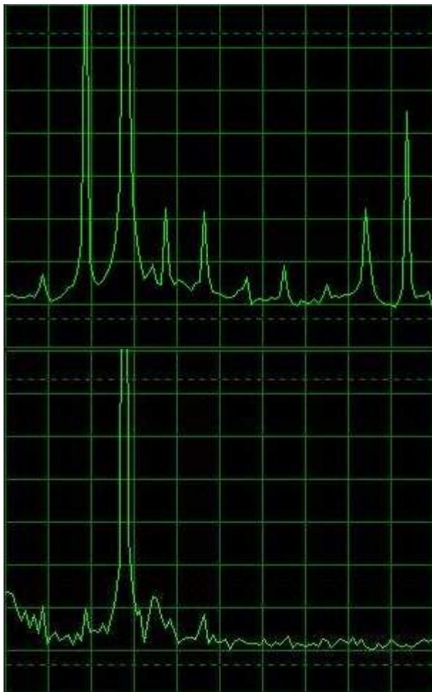
Bei der ersten Aufnahme muss die externe Lastkapazität eher gering sein, da im Vergleich zur zweiten Aufnahme eher wenige Oberwellen gedämpft wurden und deshalb die Grenzfrequenz höher liegen muss.
